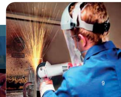
Круги малого диаметра с креплением 3M™ Roloc™ предназначены для локальной обработки сварных швов и обработки труднодоступных мест.
