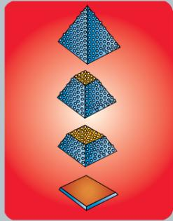
Структурированные шлифовальные материалы Trizact™ созданы по технологии микрорепликации, с помощью которой на основу наносятся прецизионные пирамидальные структуры, содержащие множество слоев тщательно отобранных абразивных частиц. По мере износа пирамидок обнажается новый слой абразива со свежими режущими кромками.
